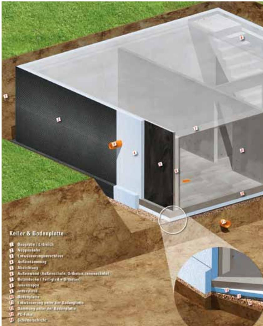
Ein Bürkle-Keller besteht aus vielen Schichten. Diese schützen besonders die Außenwände und die Bodenplatte aus Beton vor Feuchtigkeit und Wärmeverlusten.
